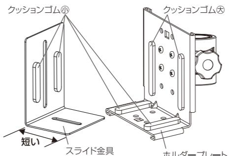
②スライドホルダープレートをホルダープレートに差し込みハンドルと組立ネジⒷで仮締めして下さい。
