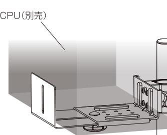
②スライド金具を調整してCPUのガタ付きをなくし、ハンドルでしっかりと固定して下さい。
