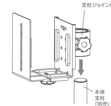
②任意の高さに調整後、支柱ジョイントに付いているハンドルでしっかりと締め付けます。
