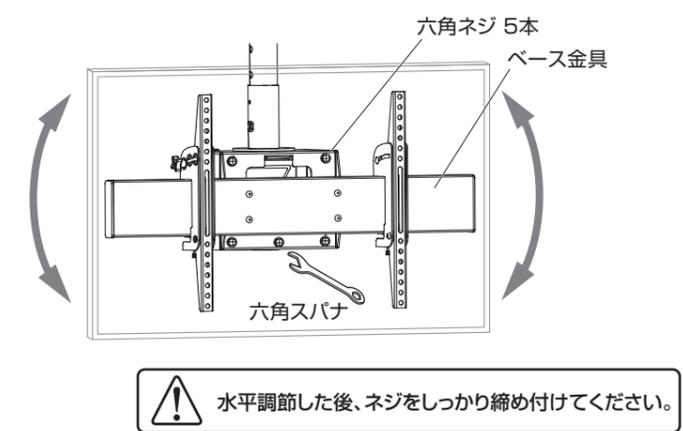
水平調節した後、ネジをしっかり締め付けてください。
