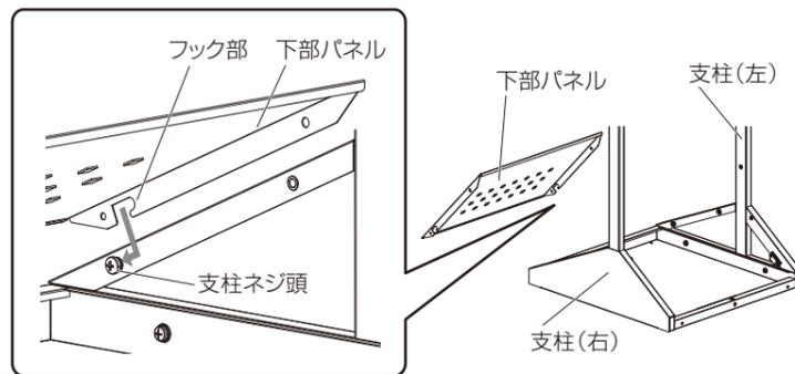
②支柱に下部パネルを組立ネジ(ワッシャー付)で固定します。※2カ所
