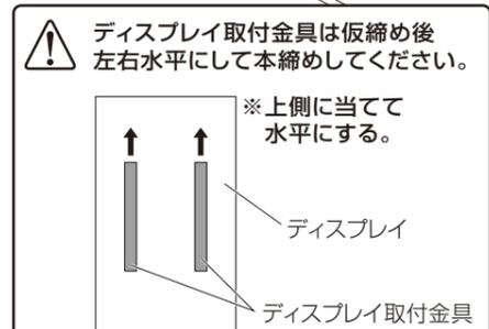
ディスプレイの上下とディスプレイ取付金具の上下に注意して取り付けてください。
