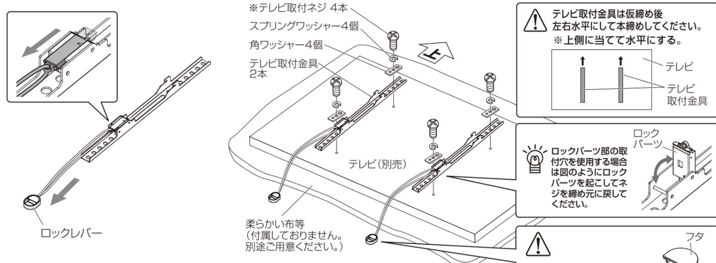
⚠️ テレビ取付金具は仮締め後左右水平にして本締めしてください。※上側に当てて水平にする。
