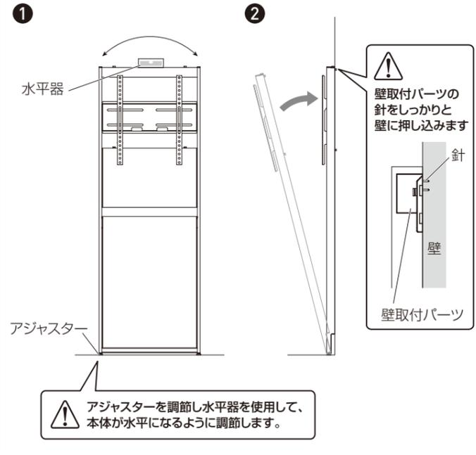
②固定ネジを外し、壁取付パーツが壁から外れないように静かに本体を外します。
