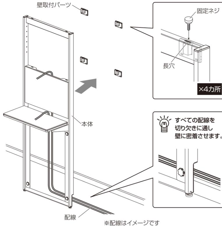
💡 すべての配線を切り欠きに通し壁に密着させます。
