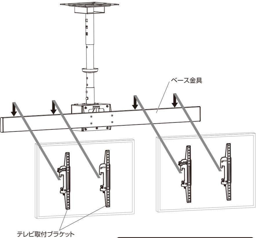
②図の様に締付ネジを六角レンチで固定します。
