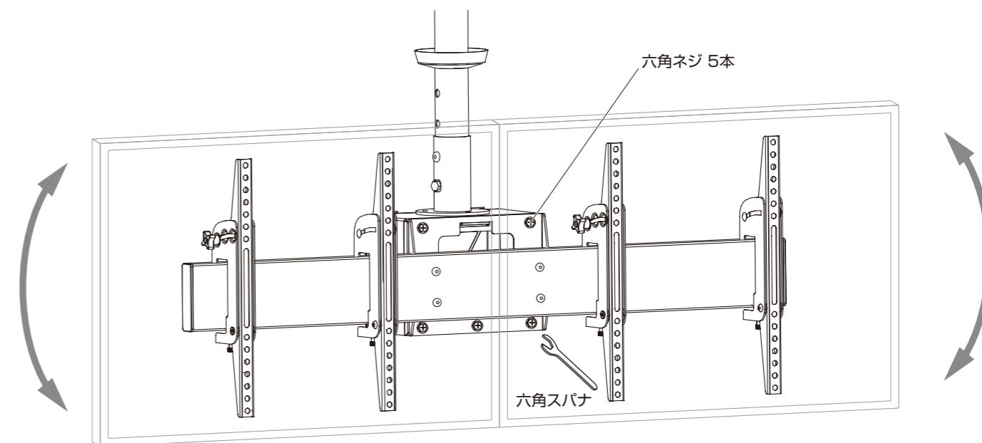
水平調節した後、ネジをしっかりと締め付けてください。
