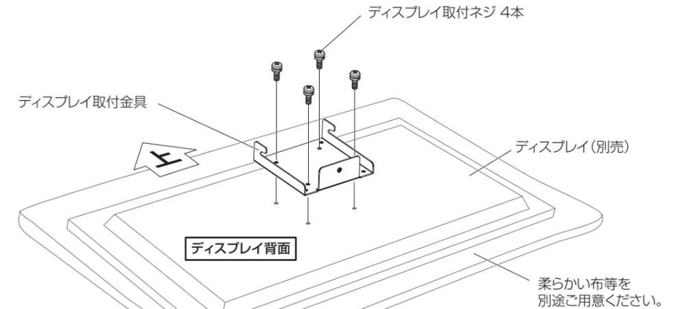
ディスプレイ取付金具は仮締め後水平にして本締めしてください。
