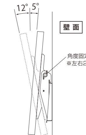
💡 角度調節した後は、必ず角度固定ノブをしっかりと締め付けてください。
