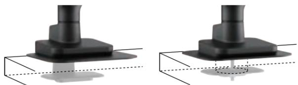
天板などに挟み込むクランプ式、穴に通す穴固定式の2WAY設計で、用途に合わせた設置が可能。
