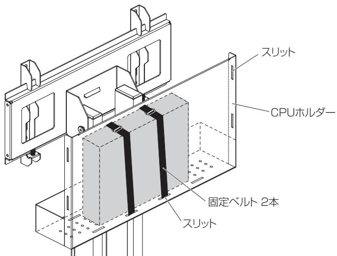
機器落下防止のために付属の固定ベルトをスリットに通し固定してご使用ください。
