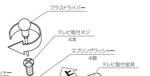
②テレビ取付金具に組立ネジ①をしっかりと締め付けます。
