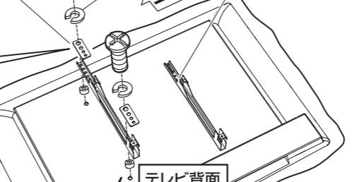
③テレビ取付金具の穴に六角穴付ボルト④を通し、スライドナットに締め付けます。六角穴付ボルト④を締め付けていくと、テレビの垂直方向の微調整が行えます。
