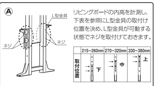
次に、下部フレームを①底板部4本、②天板裏2本の順に組立ネジ①を六角レンチ④で取付け、図Aのネジを締め付け固定します。
