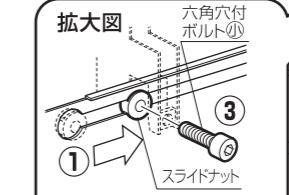
④テレビ、機器の配線を行い、①で外した裏板を再び取付けます。
