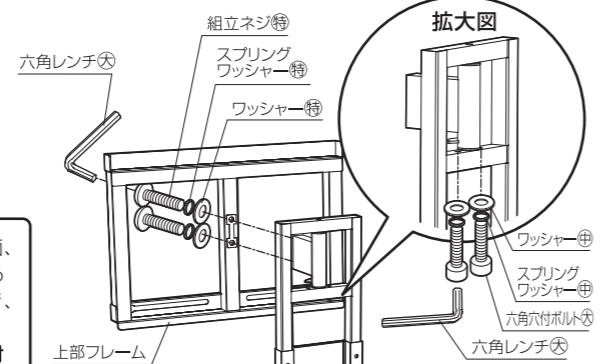
拡大図をご覧になり、スプリングワッシャー④、ワッシャー⑤の順にセットした六角穴付ボルト④を六角レンチ④で取付けます。
