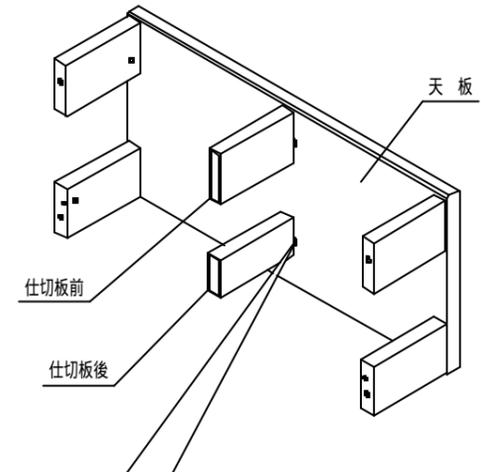
1. 天板裏に埋め込んであるジョイント部品のプラスネジを左に回し、ツメを開の状態にします
